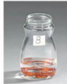
Frasco 8. Clavo cubierto con alambre de cobre sumergido en agua.
